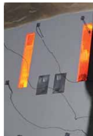
Türflügel der Drehtür nach 120 Minuten Brandprüfung
